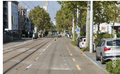
Die schmalen Velostreifen am Spalenring führen gefährlich nahe an parkierten Autos vorbei
